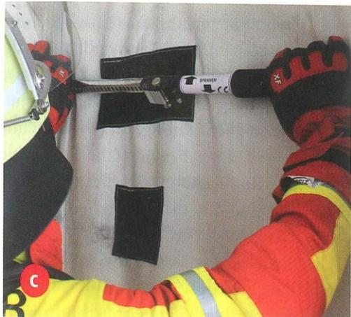
Zum Verspannen die Spannstange mit der rechten Hand in Pfeilrichtung >Spannen< drehen.
