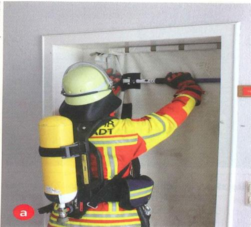
Der mobile Rauchverschluss wird rechts oben in der Türzarge eingesetzt, ...
