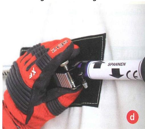
Durch Drücken des Sicherungsstiftes an der Sperrklinke wird die Spannstange verriegelt.
